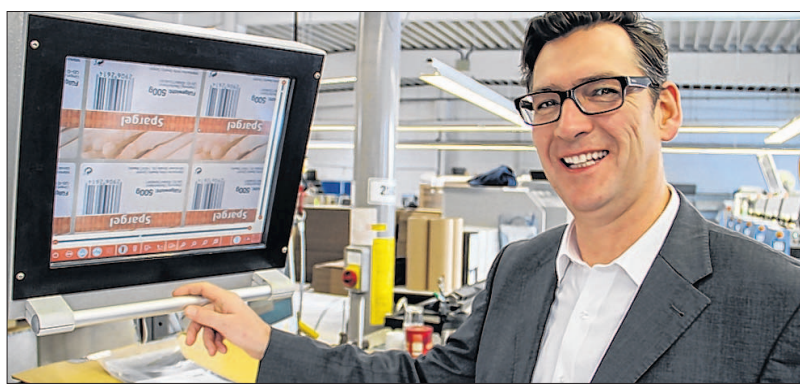
Firmeninhaber Kai Pockrandt zeigt einen Monitor, an dem die Qualität der Etiketten überwacht wird.
